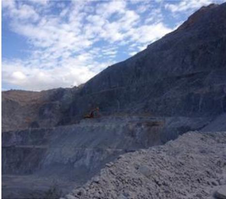
La explotación de la cantera, se lo realiza a través de varias capas con la finalidad de aprovechar la pendiente de la montaña, de esta forma la cantera adquiere la forma típica escalonada.
